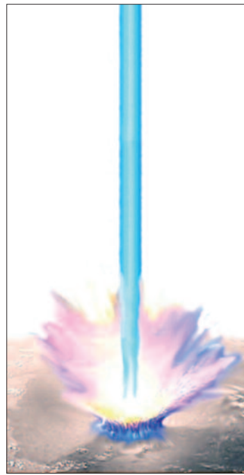
Abb. 35: Schematisch dargestellter Abtrag von Partikeln aus einer Münze mittels Laser (Laserablation). Die Explosion ist mikroskopisch klein, mit dem Auge ist lediglich das dabei entstehende Plasma als ein winziger Plasmakegel erkennbar.
