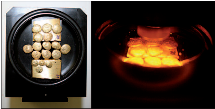
Abb. 38: Münzen (Keltensatere) in einer Laserkammer. Die Weiterentwicklung von Laserkammern an der Universität Hannover erlaubt einen sehr hohen Durchsatz an Münzen bei gleichzeitig sehr hoher Präzision.
