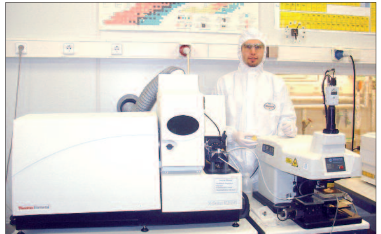
Abb. 40: Dr. Robert Lehmann analysiert im Reinraum mittels eines von zwei Laserablation-Massenspektrometern eine Goldmünze auf ihre Echtheit. Die Reinraumbedingungen garantieren eine kontaminationsfreie Messung, was die Auswertung besonders vieler Spurenelemente ermöglicht, was wiederum die Präzision der Entscheidung echt/falsch erhöht.
