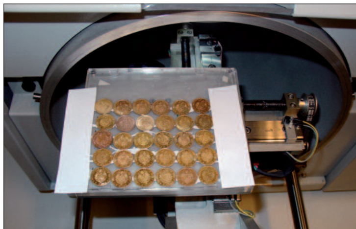
Abb. 30: Messkammer einer \mu -RFA mit für eine Reihenmessung positionierten Münzen (hier: Reichsgold). Das Gerät erlaubt einen hohen Durchsatz an Münzen bei gleichzeitig geringem Kostenaufwand.
