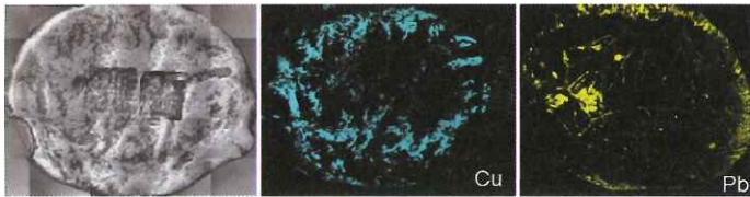
Abb. 4: Foto eines mittelalterlichen deutschen Silberbarrens (links) und dazugehörige Elementverteilungskarten für Kupfer und Blei. Helle Bereiche stellen höhere Gehalte und dunkle Bereiche niedrigere Gehalte des jeweiligen Elementes dar. Die oberflächliche Verteilung von Kupfer und Blei lässt schlussfolgern, dass das Silber mit dem damals üblichen technischen Verfahren der Kupellation erschmolzen wurde. Dabei scheiden sich beim Abkühlen der Silberschmelze die Verunreinigungen bzw. Nebenbestandteile auf der Oberfläche ab.
